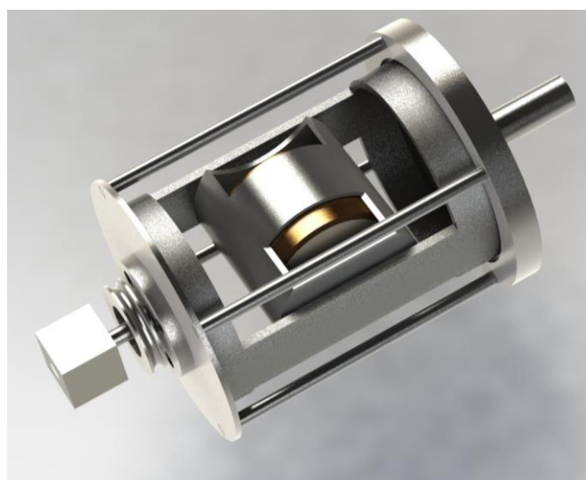
Рис. 3. Модель в сборе с гироскопическим стабилизатором
