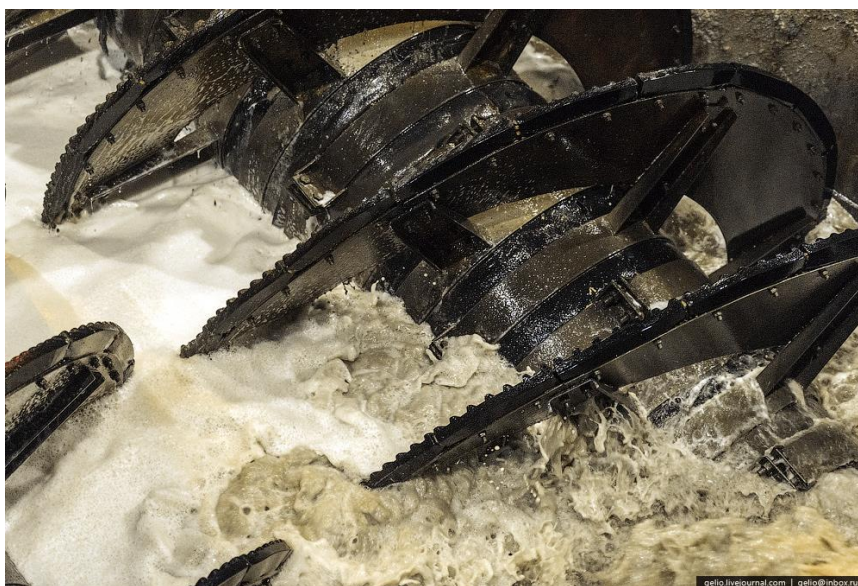
Рис. 4. Спираль классификатора 2КСН-24, оснащенная ребристой футеровкой
