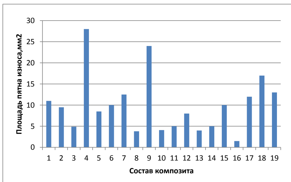
Рис. 3. Сравнительные результаты экспрессной оценки износостойкости композитов
