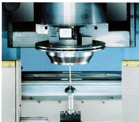
Рис. 4. Измерение параметров точности детали с помощью щупа
