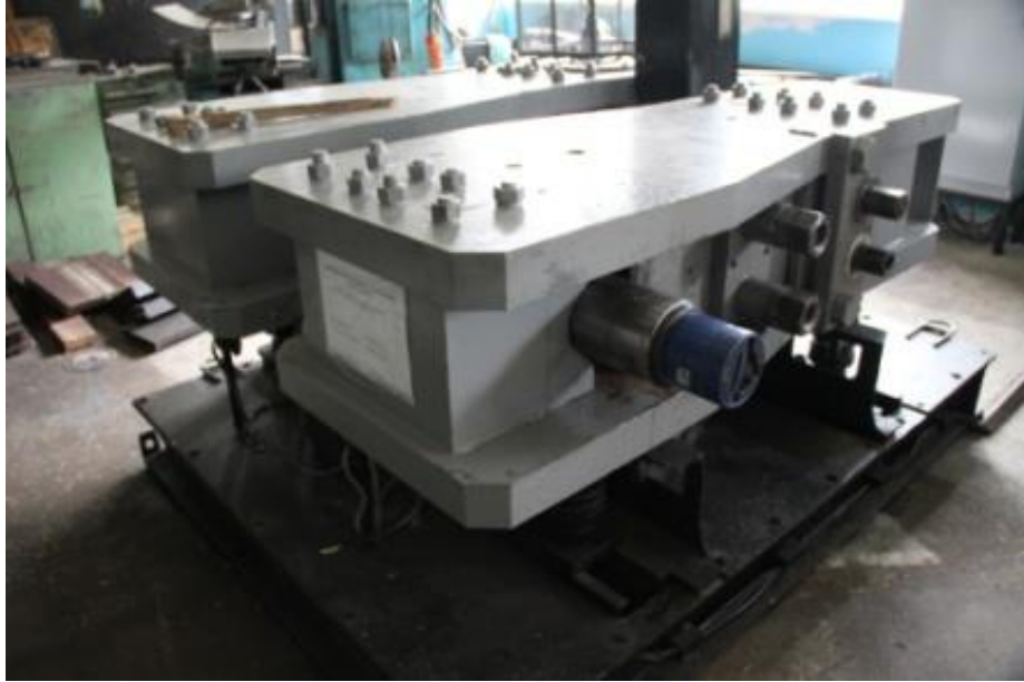
Рис. 2. Стенд усталостных испытаний
