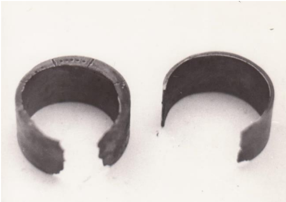
Рис. 2. Изношенные втулки, выполнявшие функцию подшипников скольжения
