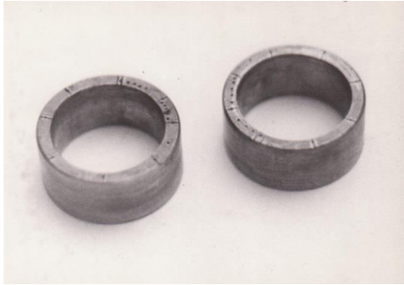
Рис. 1. Исследуемые подшипники скольжения с нанесенными искусственными базами
