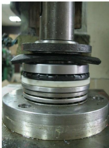
Рис. 2. Подшипник, установленный для обработки методом холодной шариковой раскатки
