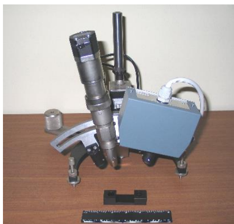
Рис. 3. Общий вид портативного рентгеновского дифрактометра
