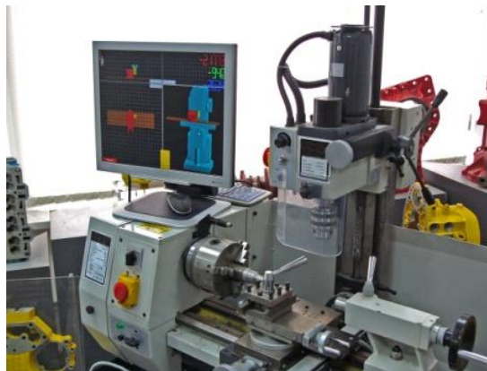
Рис. 4. Универсальный токарный станок, оснащённый интерактивной компьютерной системой управления (ИКСУ)
