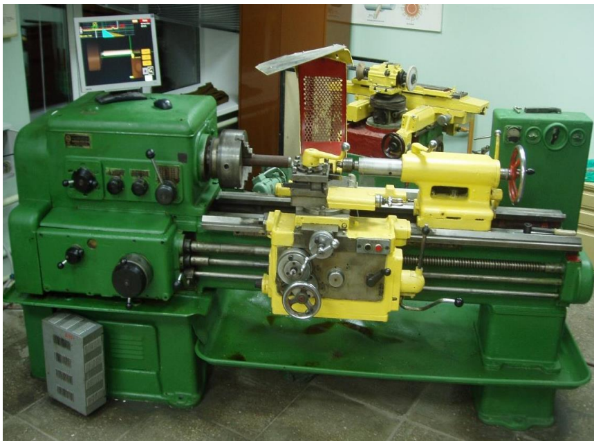
Рис. 1. Универсальный токарный станок, оснащённый интерактивной компьютерной системой управления (ИКСУ)
