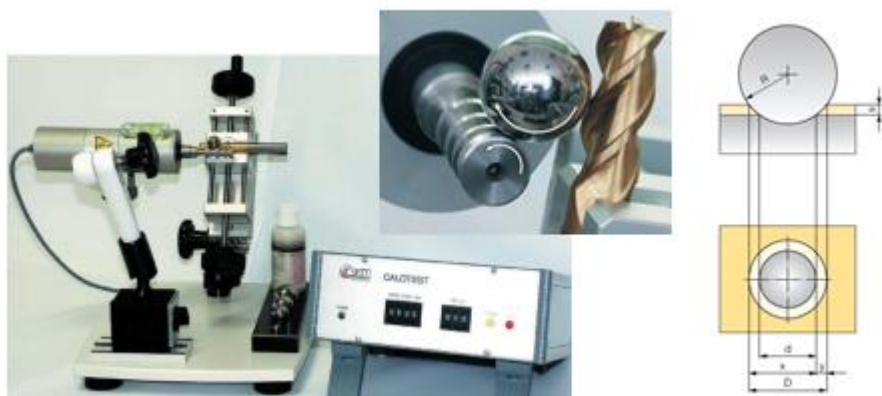
Рис. 7. Колотестер и схема его использования
