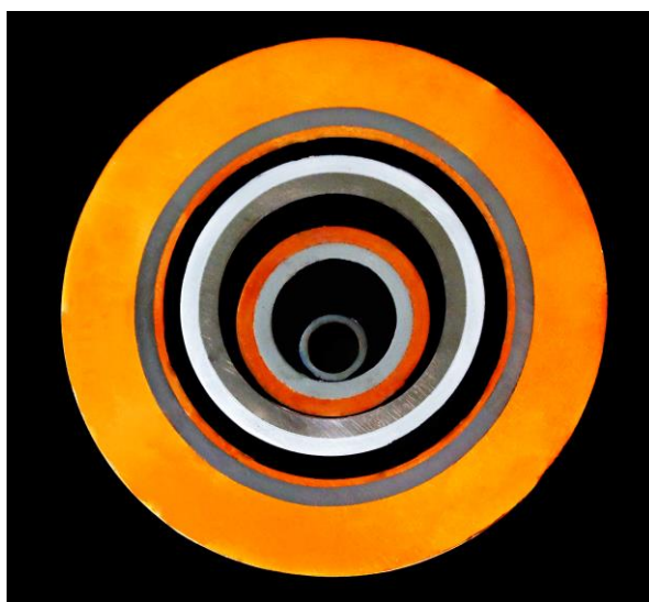
Рис. 2. Образцы биметаллических труб полученных сваркой взрывом
