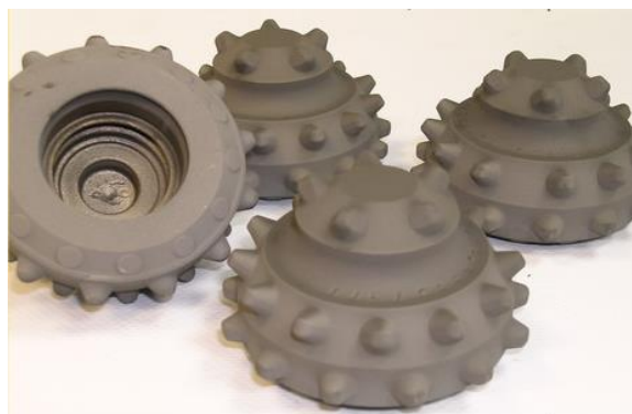
Рис. 6. Упрочненные матрицы шарошки путем высокоскоростного напыления порошков твердых сплавов
