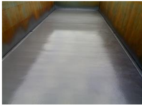
Рис. 1. Полиуретановое покрытие днища вагона думпкара
