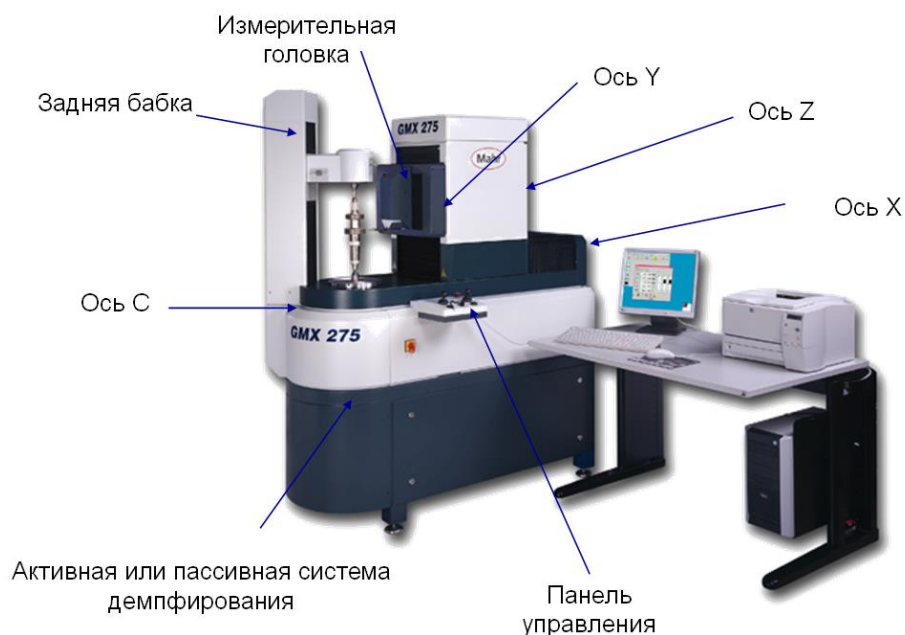
Рис. 1. Зубоизмерительный центр Mahr GMX 275
