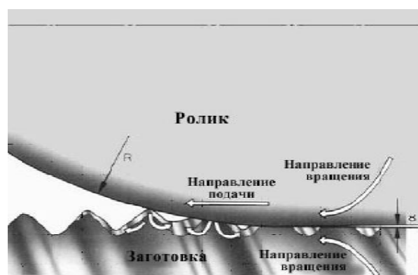
Рис. 1. Принцип накатного полирования.
