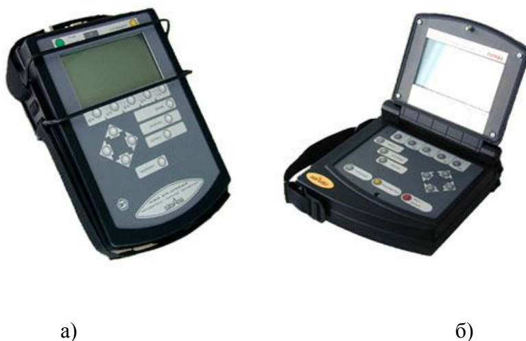
Рис. 1. Анализаторы вибрации, слева направо: «КВАРЦ» (а), «ТОПАЗ» (б)
