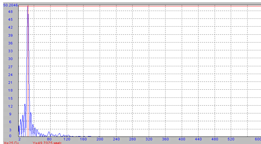
Рис. 3. Дисбаланс электродвигателя ленточного конвейера.
