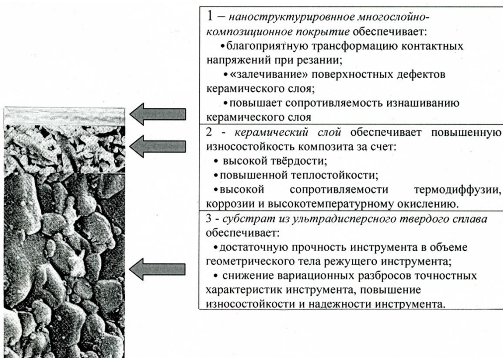
Рис.3. Концептуальная схема архитектуры высокопрочной композиционной керамики (ВВК) с наноструктурированным многослойно-композиционным покрытием.
